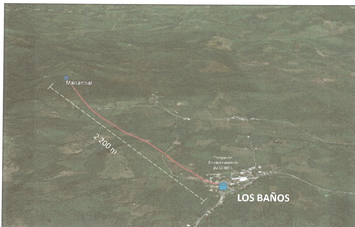
Figura 2.2.- Localización del manantial del poblado Los Baños
